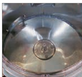
Durchsichtiger Deckel mit abnehmbarer Sprühpistole
