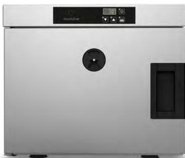
statisches Ring-Heizsystem mit Thermokabel, optimales Heißhalten durch exakte und kompakte „stille Wärme“, 2 einstellbare Entlüftungen, dichter Garraum mit Wärmeisolierung 35 mm und abgerundeten Ecken für perfekte Hygiene, niedriger Energieverbrauch, Bedienfeld mit elektronischer Einstellung für die Temperaturen, Kapazität für 3 Einschübe GN 1/1 (530x325 mm), Einschubabstand 70 mm, Temperaturbereich 30°-120° C
