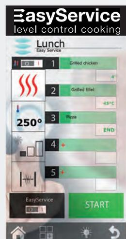
Neue Rack-Control für gleichzeitiges Garen verschiedener Gerichte auf unterschiedlichen Ebenen.
